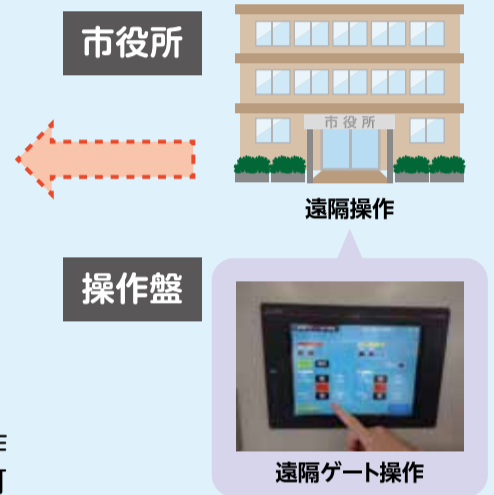
原則職員が現地で操作 緊急時は市役所から遠隔操作 退避後の状況変化にも対応可
