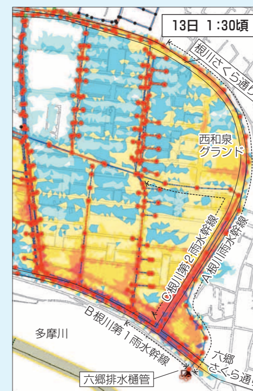
④降雨が小康状態となったため、12日23:00に六郷排水樋管を閉門し、常設ポンプにて排水を開始しました。樋管を閉門しているため、内水を排除できなくなり、徐々に浸水深は深くなりました。
