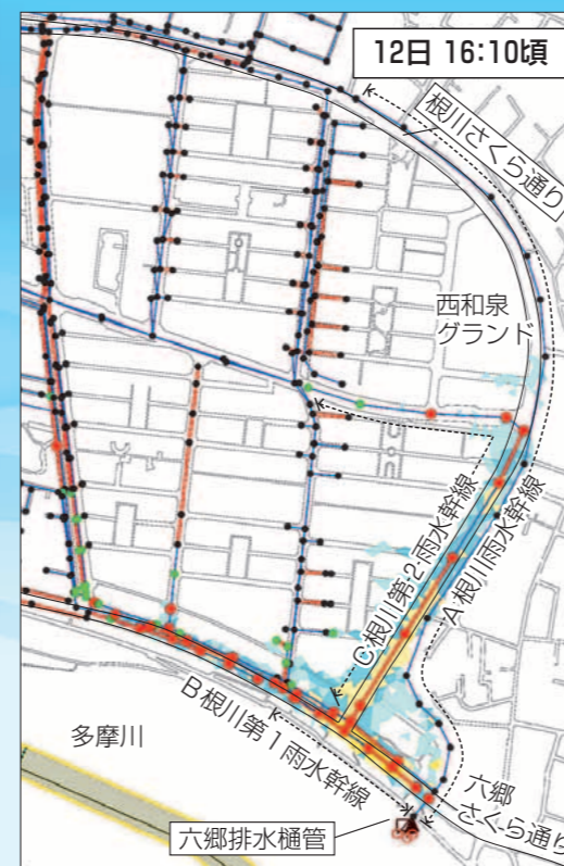
①浸水は発生していますが、A根川雨水幹線は順流で多摩川に流れています。ただし、C根川第2雨水幹線からB根川第1雨水幹線へと流れるルートにA根川雨水幹線によるバックウォーター現象が起き、内水の逆流が発生しています。(バックウォーター現象:水路等において放流先の水路等の水位の影響が上流側に影響を及ぼす現象のこと。)
