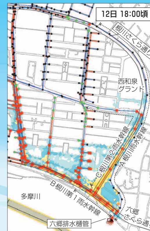
②BとCのバックウォーター現象は引き続き起こって浸水が広がっています。一方でA根川雨水幹線は順流のため、順調に多摩川へ排水できています。この後石原水位観測所水位が計画高水位を超えたため、安全を考慮して12日19:30に職員は退避しました。引き続き降雨が見込まれたこと、多摩川への流れが確認できたことにより、六郷排水樋管は開門のままとなりました。
